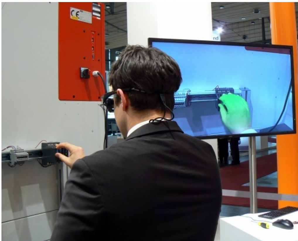
A munkás speciális szemüvegén keresztül zöld képet lát, ha a kézikönyv utasításai szerint járt el
